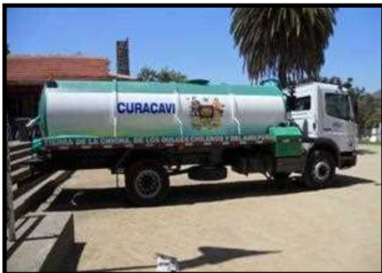
NUEVO CAMIÓN LIMPIA FOSAS ATEGO 1718 4*2 PARA LA COMUNA CON UNA CAPACIDAD DE CARGA DE 12.340 KILOS.
